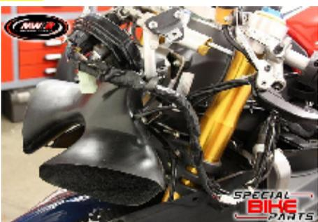
Die Ducati 1199 Panigale erlebt eine Leistungskurve durch die vergrößerten Einlasskanäle und den passenden Racing Filter. Die Zylinder werden gleichmäßig mit Luft versorgt. Deutlich bessere Laufkultur und Leistungsentfaltung!
